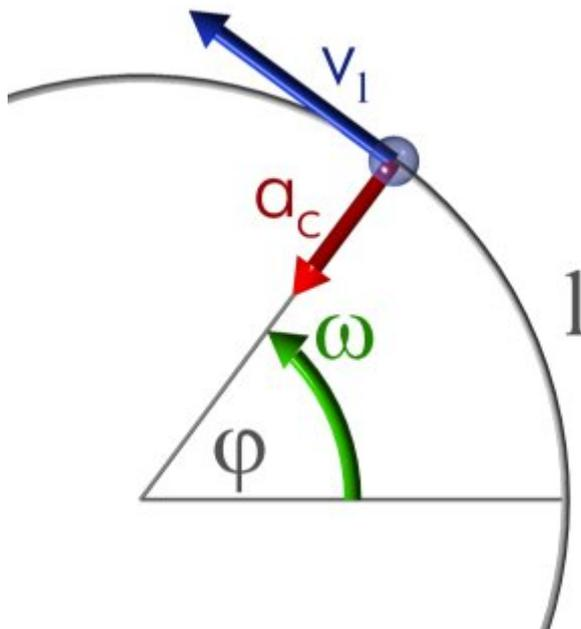
Al ser un movimiento uniforme, a iguales incrementos de tiempo le corresponden iguales desplazamientos angulares, lo que se define como velocidad angular ( $\omega$ ):
