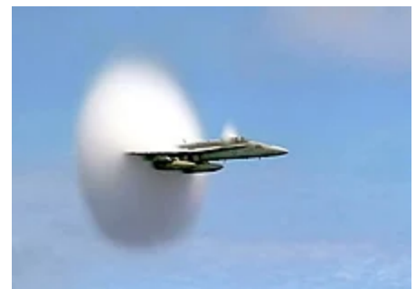
Un F / A-18 acercándose a la barrera del sonido. El halo blanco está formado por gotas de agua condensada que se cree que es el resultado de una caída en la presión del aire alrededor de la aeronave (ver Singularidad de Prandtl-Glauert).
