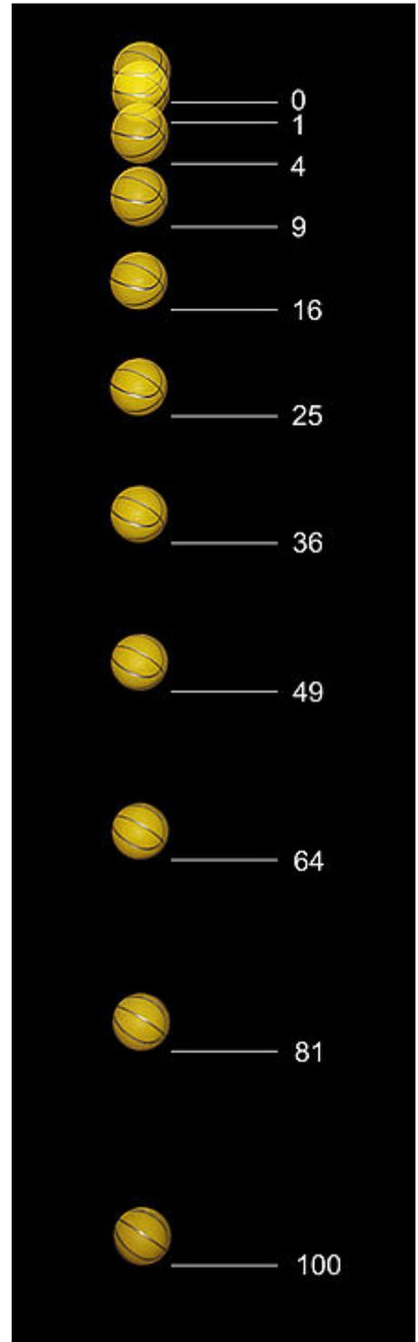
Caída libre de una pelota. Se muestran, mediante fotografía estroboscópica, las posiciones de la pelota a intervalos regulares de tiempo: para  $t = 1, 2, 3, 4, 5, \dots$ , el espacio recorrido es proporcional a  $1, 4, 9, 16, 25, \dots$ , etc.
