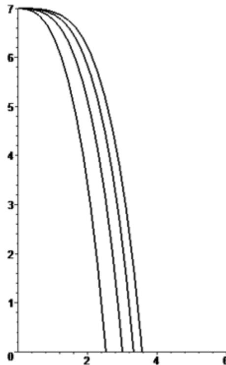
**Rozamiento  $-C_w v^2$ .** Trayectorias casi parabólicas con rozamiento proporcional al cuadrado de la velocidad, para cinco valores diferentes de la velocidad horizontal  $\beta = 1,5 - 2,5 - 3,5 - 4,5$ , desde una altura  $h = 7\delta$ .
