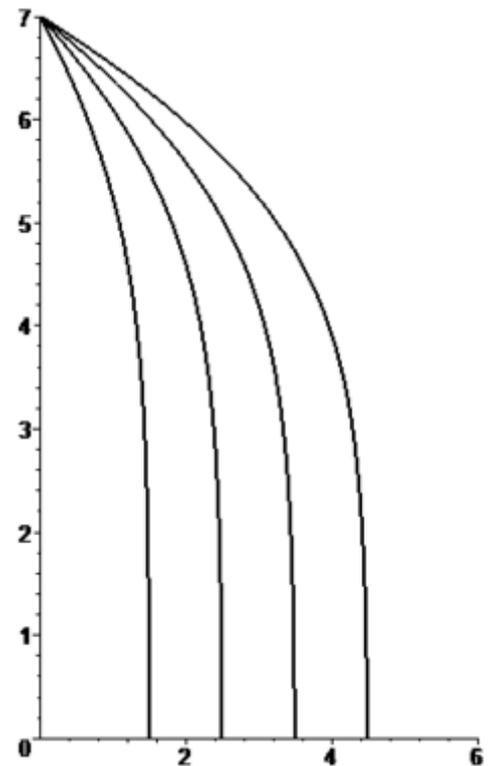
**Rozamiento  $-k_w v$ .** Trayectorias casi parabólicas con rozamiento proporcional a la velocidad, para cinco valores diferentes de la velocidad horizontal  $\beta = 1,5 - 2,5 - 3,5 - 4,5$ , desde una altura  $h = 7\delta$ .
