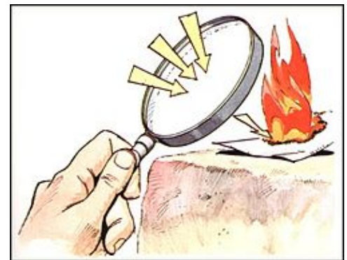
Concentración de calor radiado del sol, por procedimientos ópticos.
