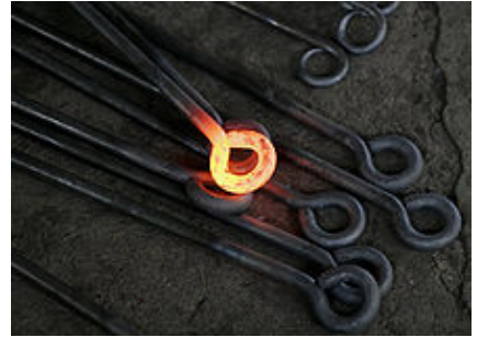
Una barra al rojo vivo transfiere calor al ambiente principalmente por radiación térmica y en menor medida por convección.
